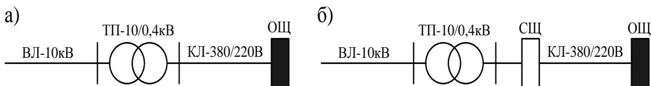
Рис. 5.1 – Схемы электропитания осветительного щита.
